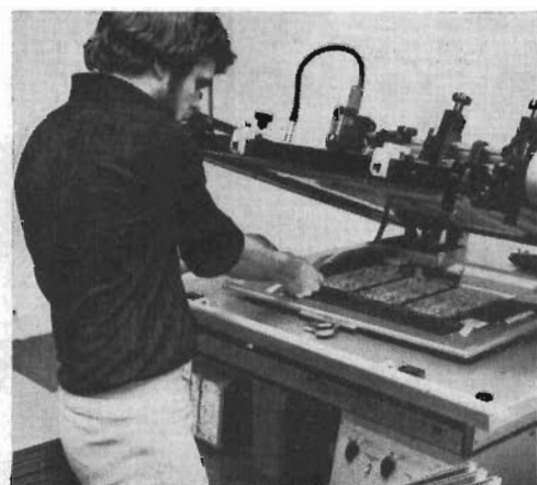
Noggrant mönstertryck – fina inställningsmöjligheter med halvautomatiskt screentryck.
