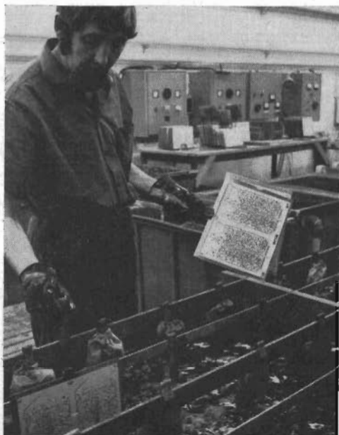
Här sker den elektrolytiska genompläteringen.
