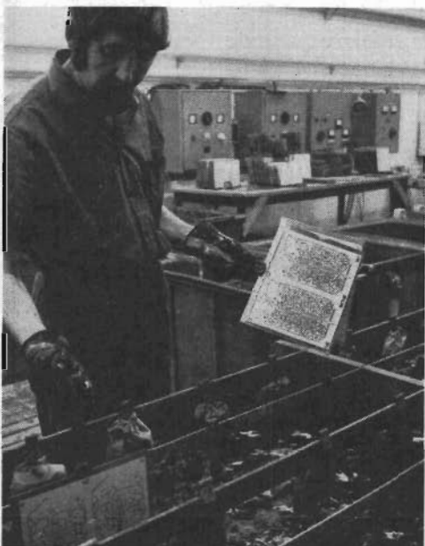
Här sker den elektrolytiska genompläteringen.
