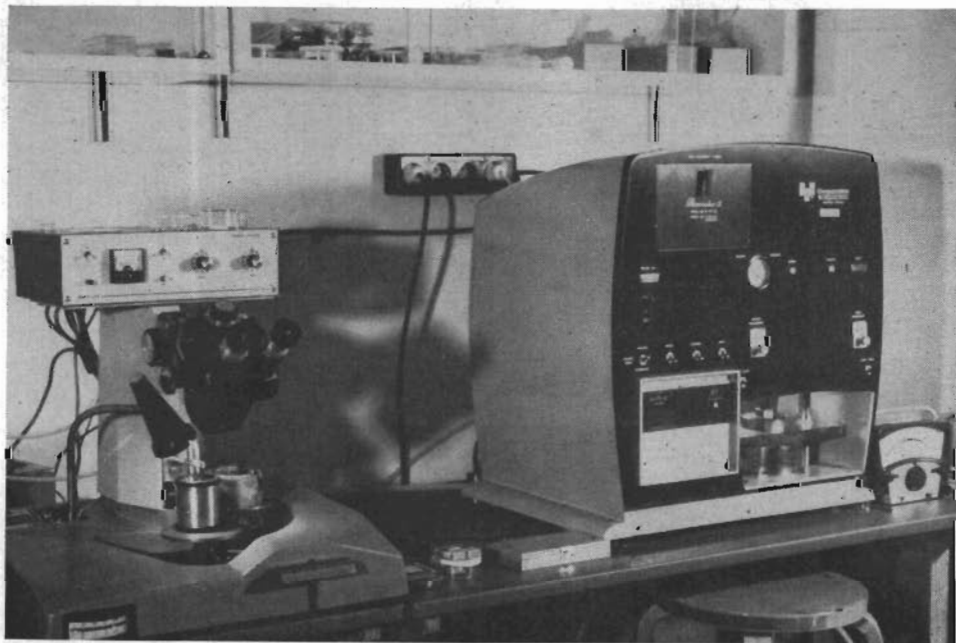
Fig 1. Halvledargruppens apparatur för montering av dioder i kapsel.
