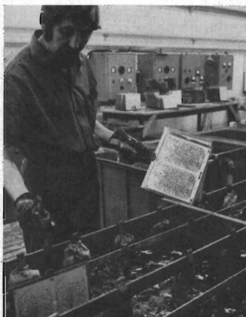
Här sker den elektrolytiska genompläteringen.
