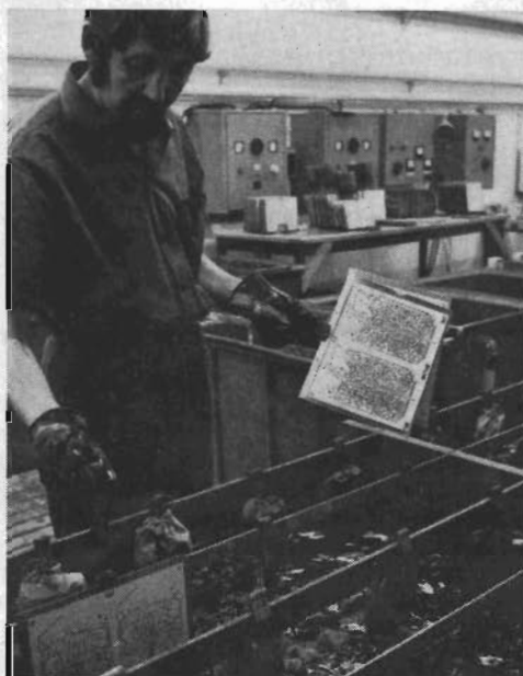
Här sker den elektrolytiska genompläteringen.
