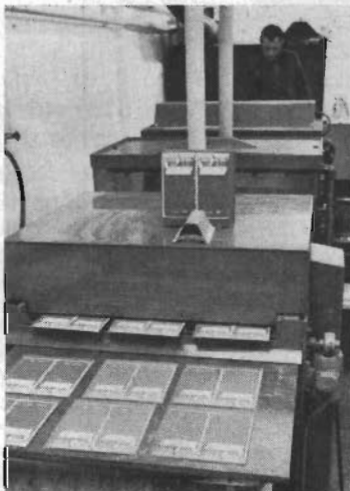
"Etsline" – maskinen etsar bort kopparn, tvättar och torkar kretsen.
