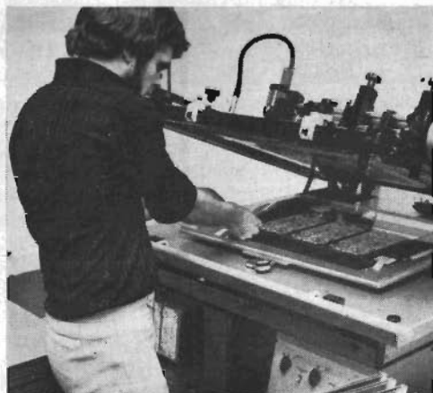
Noggrant mönstertryck – fina inställningsmöjligheter med halvautomatiskt screentryck.
