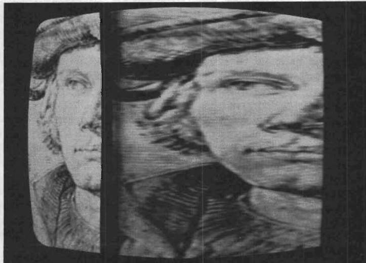
Fig 10. Det analoga skiftregistret kan också användas för tidskalning. Delbilden till vänster visas i en expanderad tidskala till höger.
