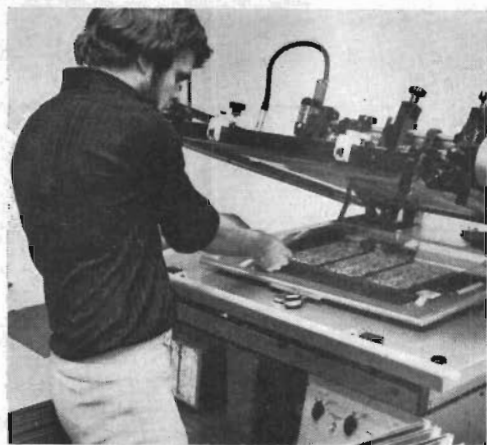
Noggrant mönstertryck – fina inställningsmöjligheter med halvautomatiskt screentryck.
