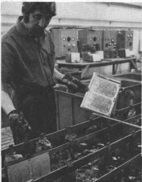
Här sker den elektrolytiska genompläteringen.
