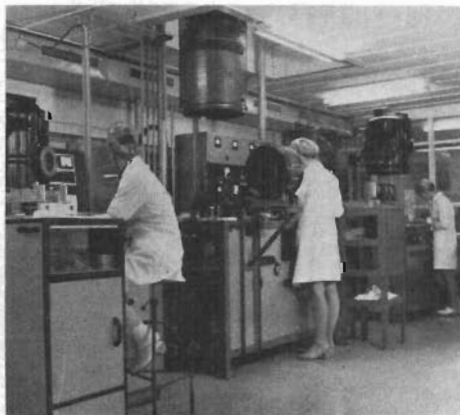
Fig 5. Vitrohms "clean room" där metallfilm motståndens stommar, även kallade "blanks" framställs.
