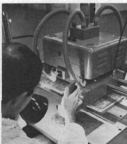
"Etsline" – maskinen etsar bort kopparn, tvättar och torkar kretsen.
