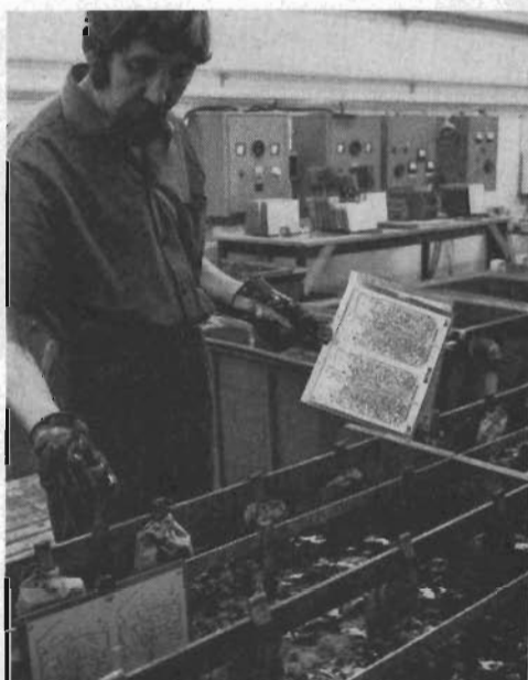
Här sker den elektrolytiska genompläteringen.
