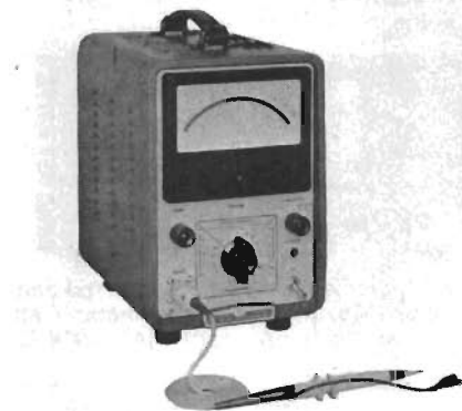
Fig 6. Hewlett-Packards mikrovolt-ampere-meter modell 425 A mäter likspänningar från 1 \mu V till 1 V i elva områden samt likström från 10 pA (fsu) till 3 mA i 18 områden. Pris: 3 510 kronor
