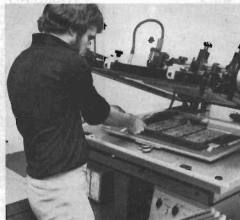
Noggrant mönstertryck – fina inställningsmöjligheter med halvautomatiskt screentryck.
