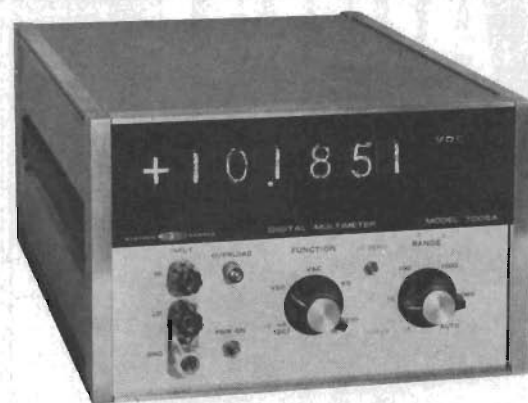
Fig 4. 5\frac{1}{2} -siffrig multimeter som i standardutförande mäter likspänningar från \pm 10 \mu\text{V} till \pm 1100 V till en kostnad av 8 800 kronor.
