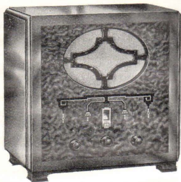
Modern svensk distansmottagare med variabel-my-rör såsom högfrekvensförstärkare. De tre rattarna äro resp. våglängdskomkopplare, avstärningsratt och volymkontroll.
