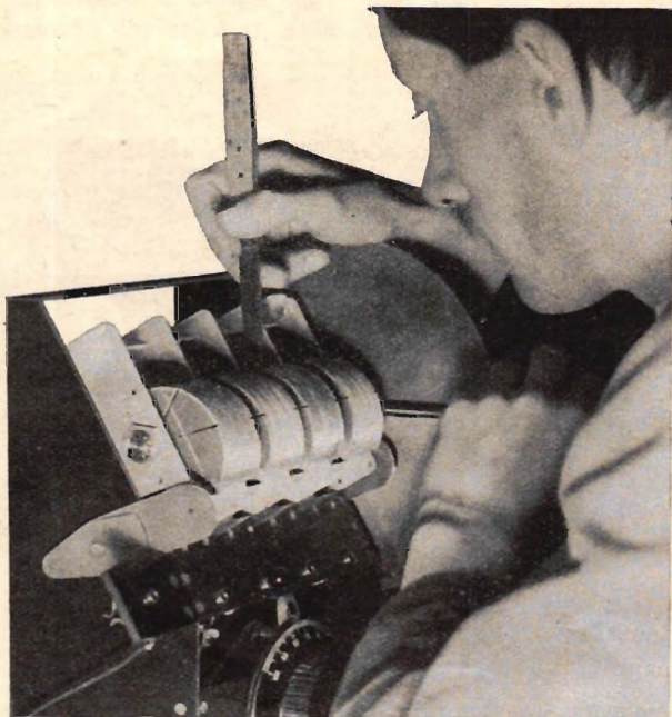
Denna bild visar hur en gangkondensator trimmas vid fabriken. En särskild liten mätsändare användes i detta fall, och flikarna på rotorändskivorna böjas i tur och ordning, till dess alla sektionerna få samma kapacitet vid varje gradtal på avstämningsskalan. (Bilden från Dr Georg Seibt Aktiengesellschaft.)
