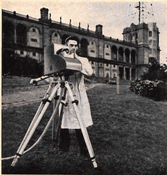
Fig. 13. En av de första Emitron-kamerorna i aktion framför Alexandra Palace. Kamerakabeln kan dragas ut till en längd av flera hundra meter utan att några svårigheter med transmissionen göra sig gällande.
