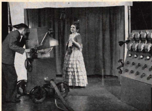
Fig. 19. Instrukтив bild från en Philips-studio med kameran från fig. 15 i aktion. Kvicksilverhögtryckslampor användas för belysningen. Lägg märke till mikrofonen snett framför den agerandes huvud. Till höger del av kraftcentralen för belysning m. m.
