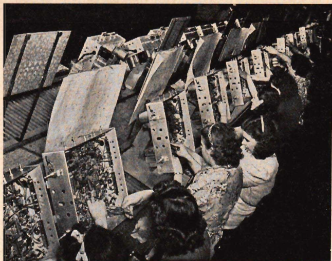
Fig. 81. En av RCA:s, Camden, monteringskedjor för televisionsmottagare. Lägg märke till förbindningsschemat över varje arbetsplats. Var fjärde eller femte »man» fungerar huvudsakligen som avsynare.
