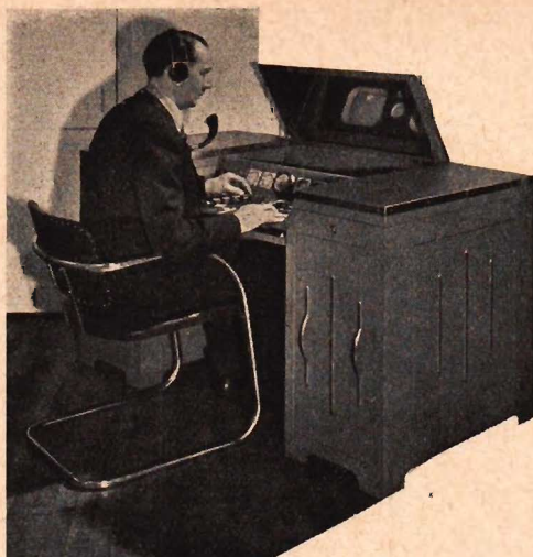
Fig. 104. En studiokontroll från Farnsworth för televisionssändare (tillhörande kontrollrumsutrustningen). Tvenne kanaler finnas med bildmonitorerna placerade vertikalt i facket bakom manöverbordet. Bilderna iakttagas via spegeln i locket.
