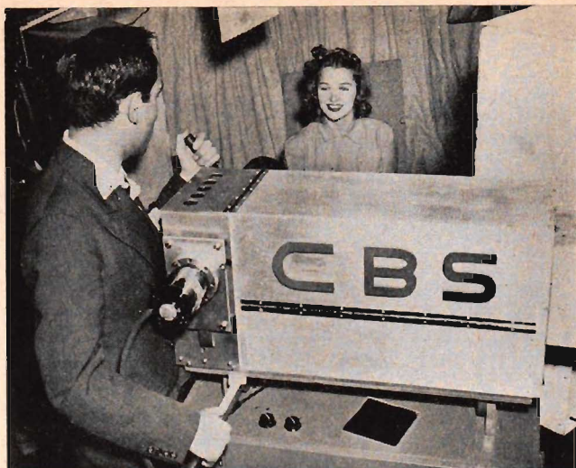
Fig. 73. Färgtelevisionen tog ett stort steg framåt i och med introduktionen av CBS 443/60-system. Övan en bild från studio för televisering i naturliga färger med övre delen av kameran, innehållande kameraröret, en ortikon från RCA.
