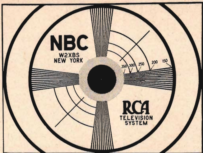
Fig. 96. RCA-NBC:s mätbild. Yttre cirklarna angiva 4:3-formatet, cirkelytorna i centrum olika svart-vit-graden. De vertikala och horisontella strålnippena medgiva bestämning av horisontella och vertikala bildkvaliteten (upplösningen).
