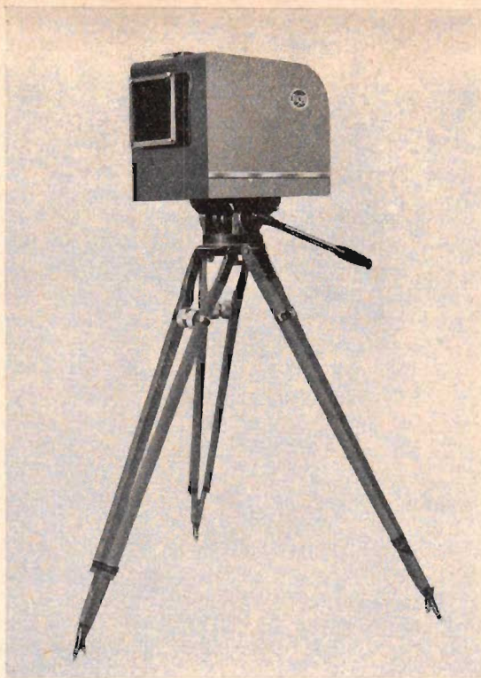
Fig. 85. En av RCA:s ikonoskopkameror för fältbruk. Mekanisk inställning av kameran — såväl som fokusering — sker med handtaget till höger. Denna kamera användes vid televisionsdemonstrationerna på världsutställningen i New York 1940.
