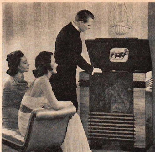
Fig. 78. RCA, modell TRK 12, är en typisk representant för de mottagare, som kommo i marknaden 1938—1939, då man försökte få igång televisionen i samband med världsutställningen. Bildstorleken är 9\frac{3}{4}'' \times 7\frac{3}{8}'' . Apparaten har 36 rör, av vilka en del tillhöra den inbyggda tryckknappsmottagaren för rundradio.
