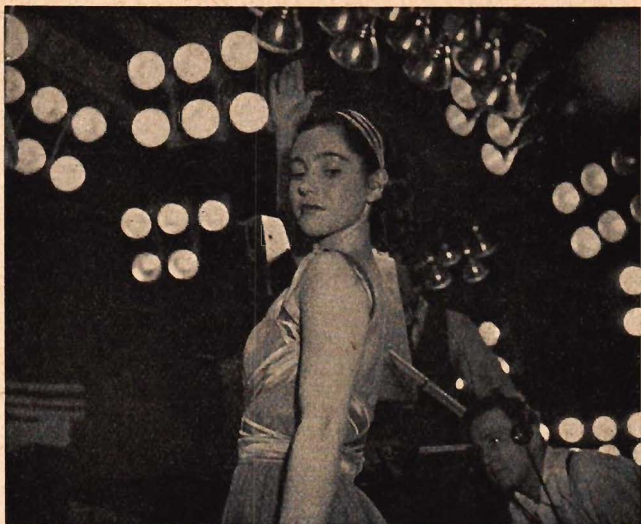
Fig. 101. Denna bild giver en god uppfattning om huru belysningen är anordnad i en modern televisionsstudio. Lamporna, i grupper om sex, ha sammanförts i motordrivna enheter, avståndsmåttade från kontrollrummet. Kameran skyntar bakom den agerande.
