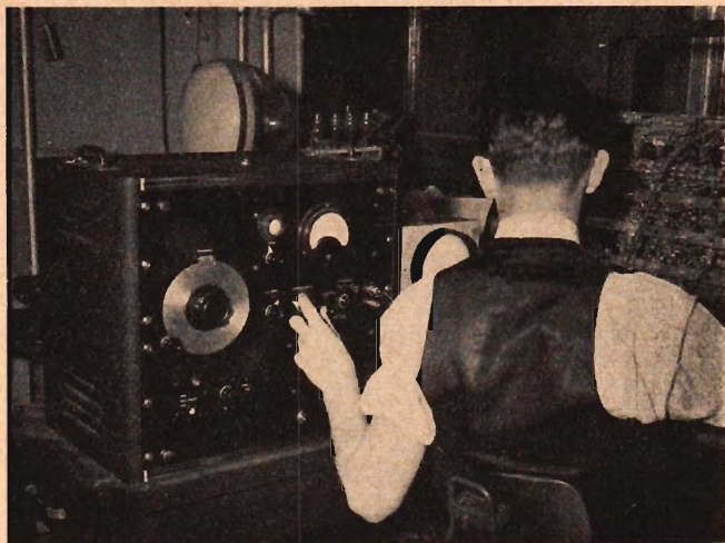
Fig. 116. Boonton Model 140-A, en representant för de moderna sväv-generatorerna för vidfrekvens. Frekvensområdet är 20 p/s till 5 Mc/s. Över generatoren syns ett Du Mont bildrör med intensifieringselektrod. (Bilden är från Du Monts laboratorium i Passaic, New Jersey.)
