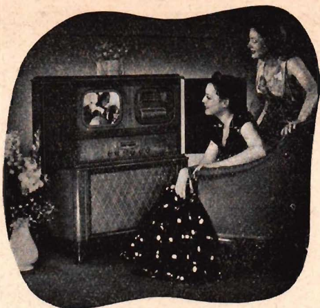
Fig. 80. En av General Electrics televisionsmottagare. Bildskärmen synes t. v. bakom ett skyddsglas. De nedtill placerade rattarna tillhöra televisionsmottagaren, som har fem kanaler; fyra för framtida sändning. Upptill t. h. en radiomottagare med kortvåg och tryckknappsinställning.
