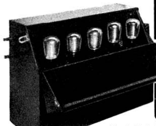
Fig. 1. Centralradiomottagaren med ackumulator och det automatiska kontrolluret.
