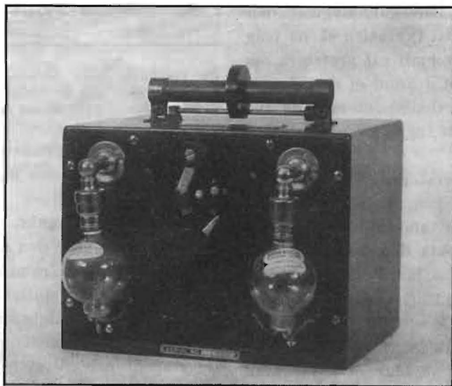
Radiomottagare Lee De Forest Audion. Ser. 114 T N F. Gåva till Tekniska Museets samlingar av Ingenjör Joh. Härdén, Stockholm.
