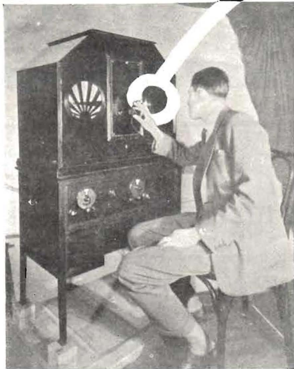
Televisionsmottagaren här ovan är så konstruerad, att den på en gång kan mottaga bildsändningen och de tillhörande ljudsensationererna, vilka återges samtidigt. Överst till höger en oretuscherad bild, som ger en föreställning om vad televisionen av år 1930 kan prestera.
