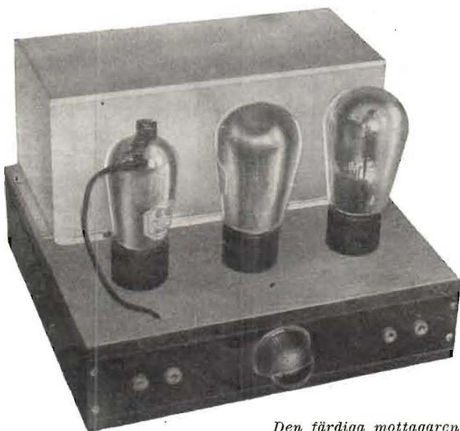
Den färdiga mottagaren med insatta rör men utan skyddshölje över dessa.
