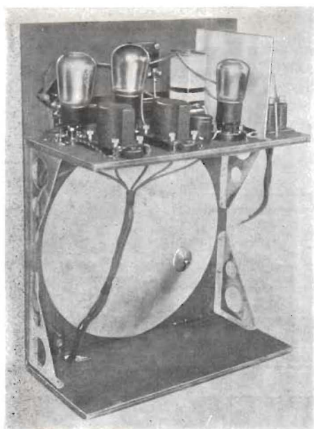
Högtalare och rör inmonterade.
