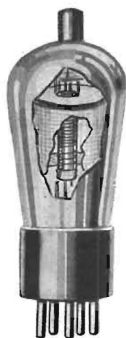
Fig. 1. Den inre konstruktionen hos det nya skärmgallerröret. K — katod. G_1 och G_2 — styrgaller. S — skärmgaller. A — anod.
