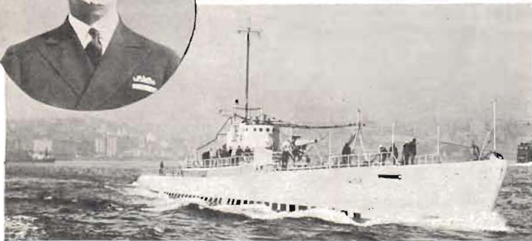
Sir Hubert Wilkins och undervattensbåten »Nautilus». Observera det speciella antennsystemet för radiotelegrafering under vattennytan.
