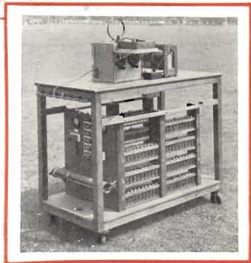
Fig. 2. Den av Smith-Rose använda ultrakortvågsändaren med en ramantenn på ett enda trådvarv.
