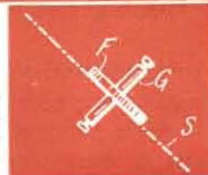
Fig. 3. Ett praktiskt sätt att ordna antennenomföringen i ett tält.
