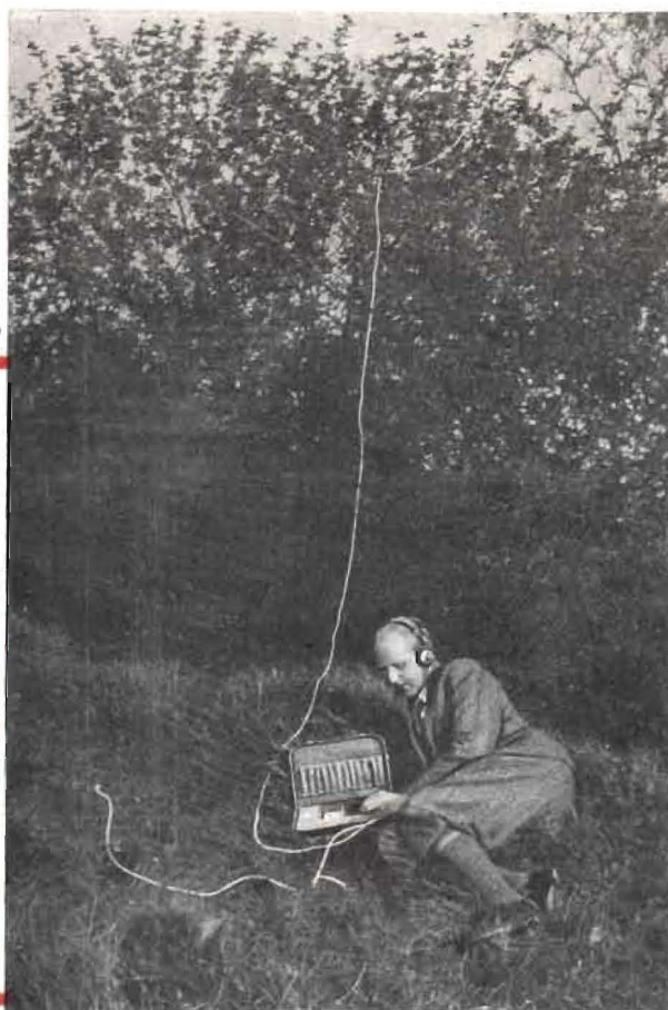
En isolerad koppartråd som antenn ute i det fria. Jordledningen består här av ett i marken nedslaget metallrör.
