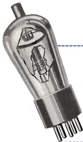
Fig. 1. Dubbelgallerrör. Styr-gallret närmast anoden.
