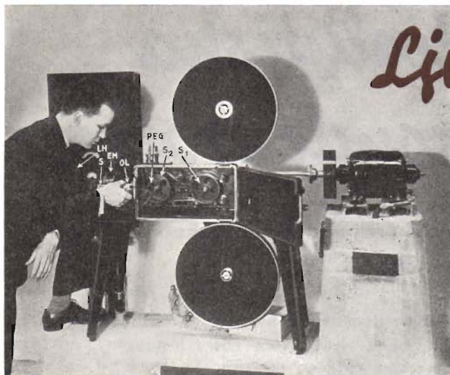
En ljudupptagningsapparat enligt system »Western Electric».
