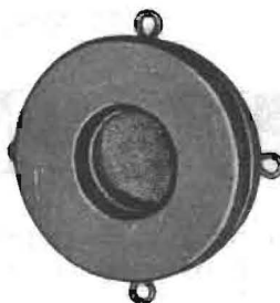
Fig. 4. Kondensatormikrofon sedd framifrån, utan förstärkare. I schemat nedtill är K mikrofonen, B mikrofonbatteriet och R kopplingsmotståndet.
