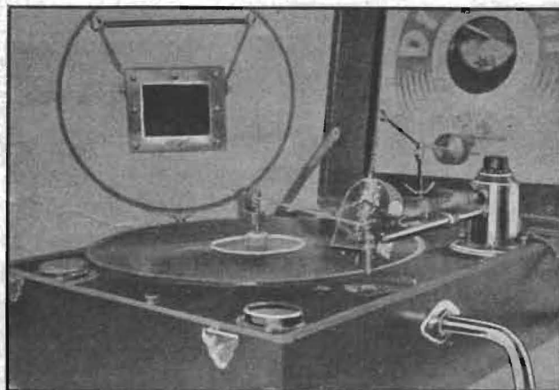
Graverdosa med styrmekanism, apterad på en vanlig bordsgrammofon. I bakgrunden ses reismikrofonen, upphängd i sitt stativ.
