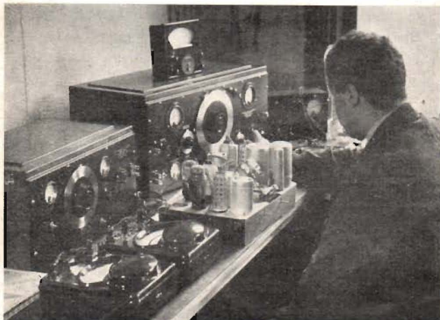
Ett hörn av laboratoriet med den stora signalgeneratoren i bakgrunden. Ett mottagarchassi är just under utprovning.
