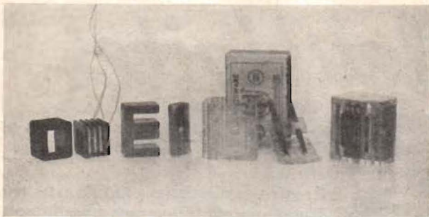
Fig. 3. Hur en ferrocarts pole är sammansatt. Från vänster till höger: olindad spolstomme, färdiglindad spolstomme, ferrocarts kärna i två delar, spolburk av trolitul med kontaktförsett lock samt den färdiga ferrocarts polen. (Detta är blott kortvågssektionen för 200—600 m.) Storleken kan bedömas genom jämförelse med tändsticksasken i mitten.
