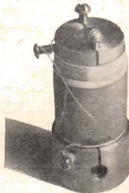
Fig. 5. Anordning för lindning av mellanfrekvensspolarna, då dessa skola luftlindas.
