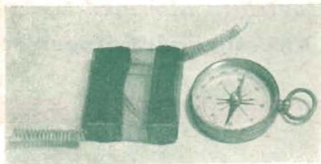
Fig. 2. Delarna till galvanometern eller nollinstrumentet. En vanlig kompass förses med en lindning på 200 varv. En Mavometer kan också användas som nollinstrument.
