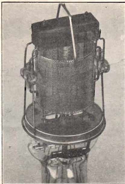
Fig. 7. Elektrodssystem till högfrekvenspentod. Skärmhuvu upptill utgör en fortsättning av skärmgallret.
