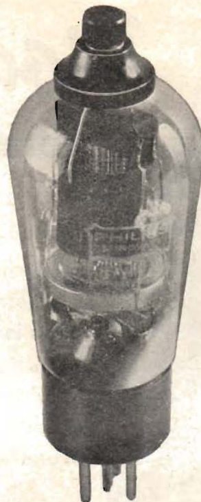
Fig. 5. Högfrekvenspentoden är det moderna röret för högfrekvensförstärkning. Genom sitt stora inre motstånd utövar detta rör ingen märkbar dämpning på stämkrätsarna.
