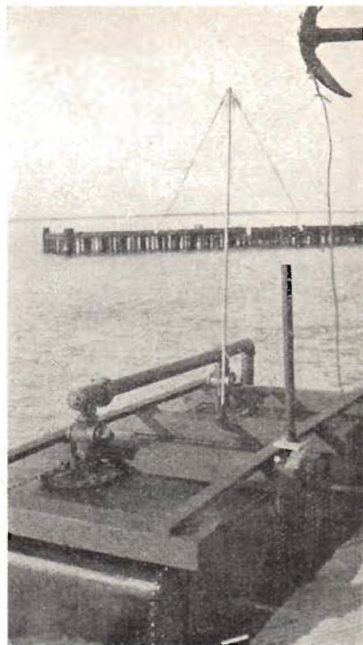
Fig. 5. Sändarantenn för ultrakortvåg, monterad på en ponton.
