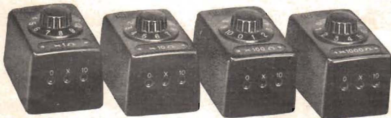
Dekadmotståndsenheter med vridomkopplare. Finnas från 10 \times 0,1 till 10 \times 10.000 ohm. Tidskonstanten varierar mellan 135 \times 10^{-3} och 7 \times 10^{-3} .
