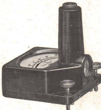
»Mirravi», kombinerad visare- och spegelgalvanometer.
