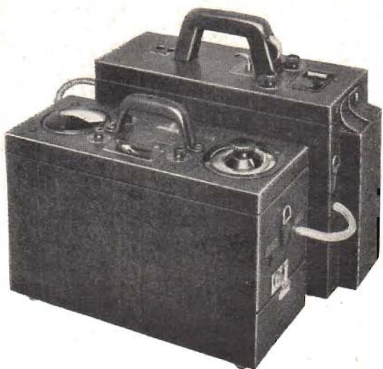
Fig. 2. Siemens' störningssökare (den större väskan) med tillsatsapparat för störningsmätning. Den senare innehåller en högfrekvensspänningsdelare samt en impulsmeter och sammankopplas medelst korta, skärmade kablar med störningssökaren. Störningsspänningen, som skall mätas, inmatas på tillsatsapparaten, som för detta ändamål har tre stycken klämskruvor placerade innanför luckan på ena kortsidan.
