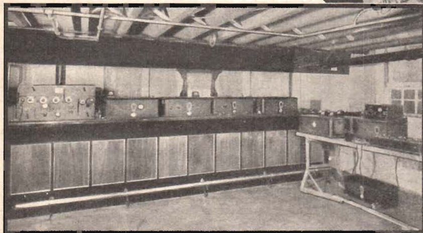
Här ovan ses Armstrongs sändare med sina 73 rör och till vänster mottagaren, som har ej mindre än 25 rör.
