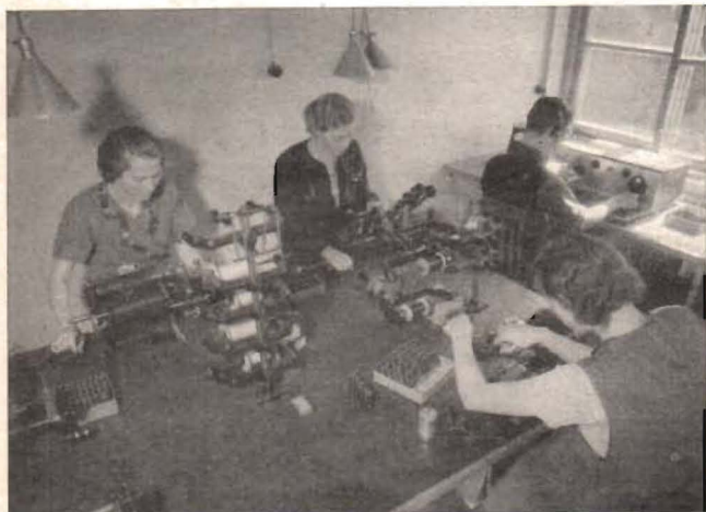
Ett hörn av lindningsavdelningen. Vid fönstret en apparat för justering av spolarnas induktans.
