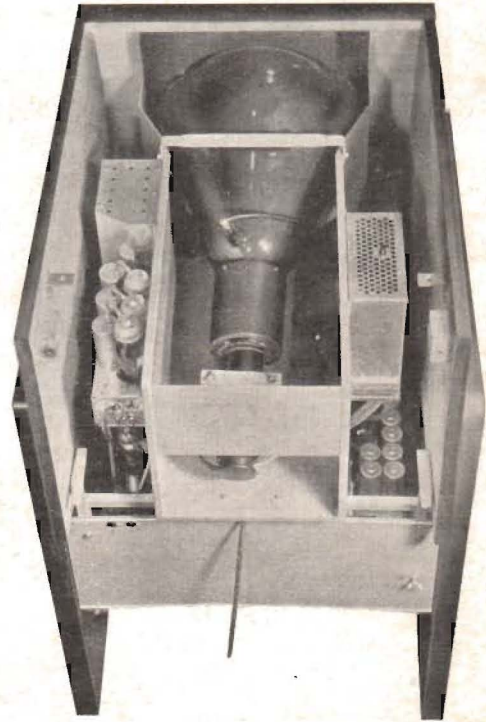
Fig. 3. Interiör av Telefunkens televisionssuper.
