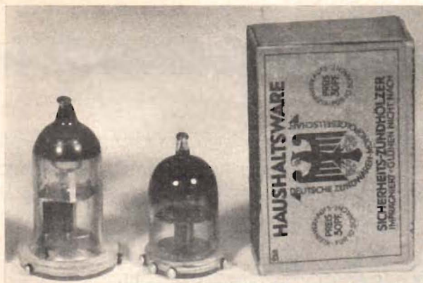
Fig. 3. Telefunkens dvärgrör för mottagning av decimetervågor.
