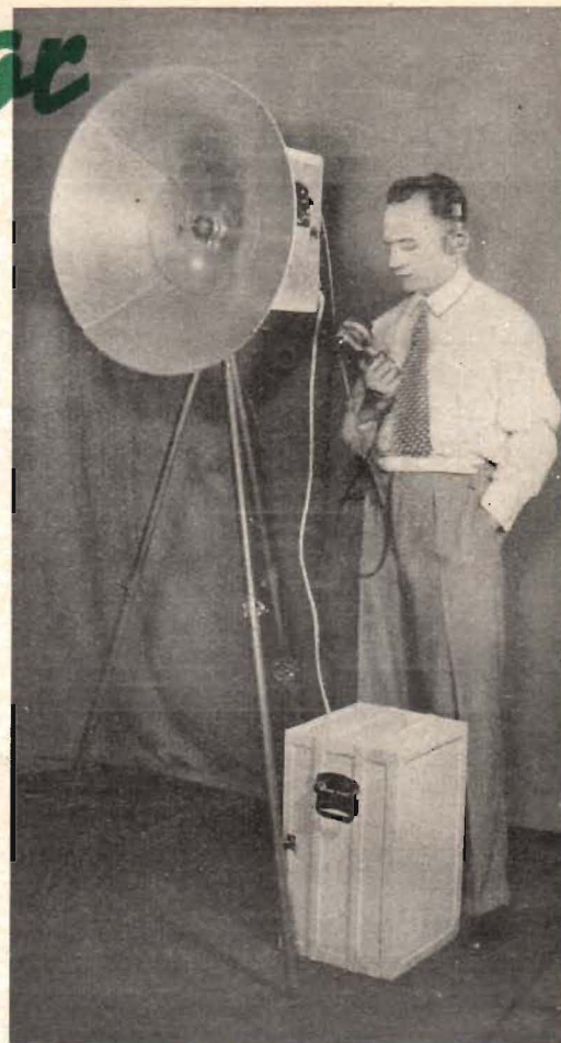
Sändare och mottagare med parabolisk reflektor. I dennas brännpunkt befinner sig den lilla dipolantenn, som ses i fig. 4.
