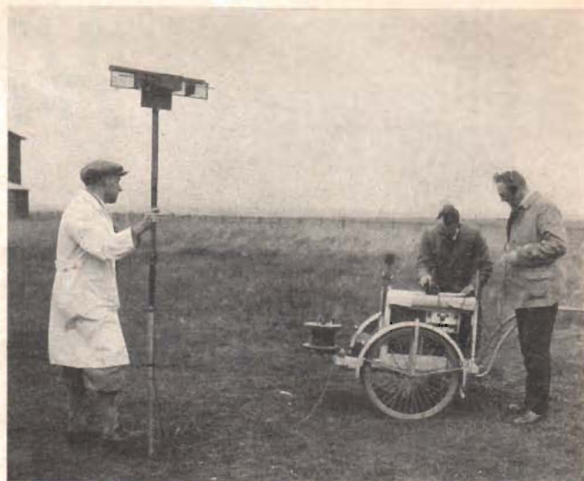
Fig. 5. Mottagare för decimetervågor, använd vid försök ute i terrängen. Uptill på stängen ses dipolantennen med reflektor.
