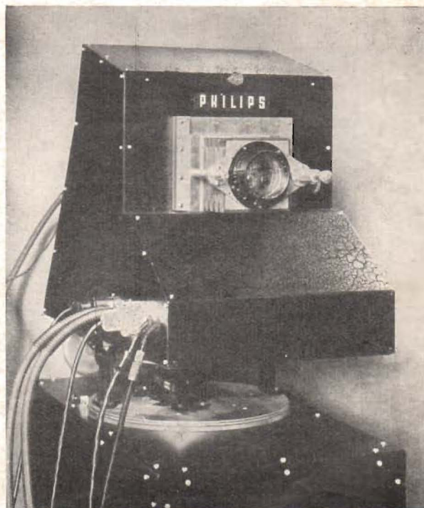
Fig. 1. Philips' televisionskamera med ikonoskop.
