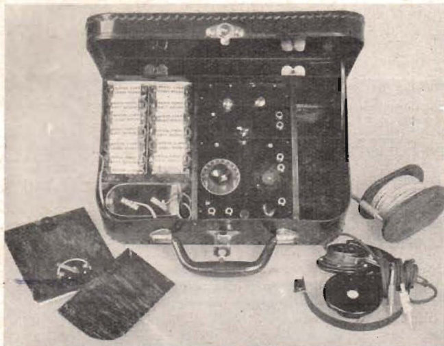
Apparaten med locken till batterifacken borttagna. Hörtelefonen samt vindan för antenn- och jordledningar ha tagits ur sitt fack. Detektorröret sitter till höger på panelen, slutröret till vänster.
