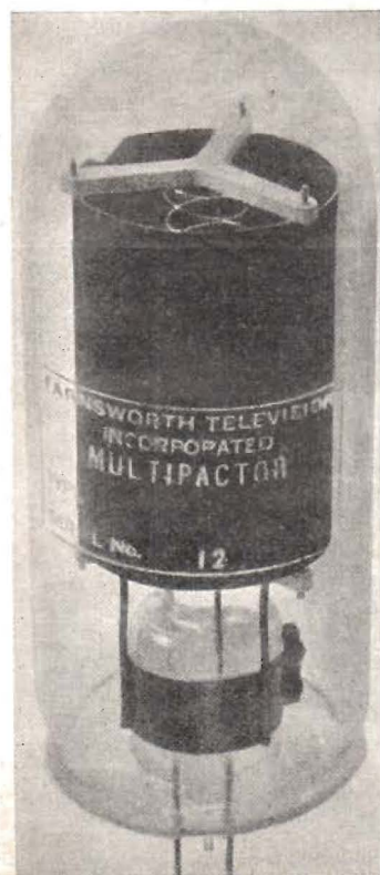
Fig. 12. Farnsworth's multipactor. Det mellersta röret kan avge 1/2 kW.
