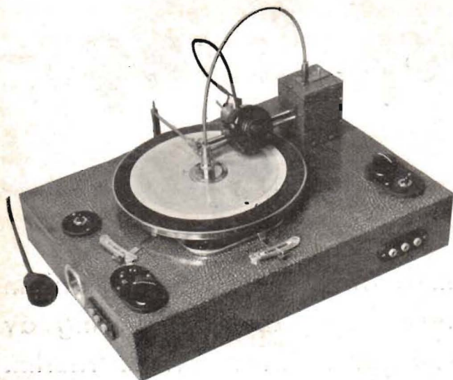
Inspelningsapparaten komplett. Till höger ses växellådan med den böjliga axeln från centrum av skivtallriken.
