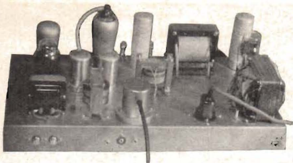
Förstärkaren enligt schemat i fig. 2, sedd från baksidan. Vinjettbilden visar samma förstärkare samt kristallmikrofonen, monterad på ett bordsstativ.
