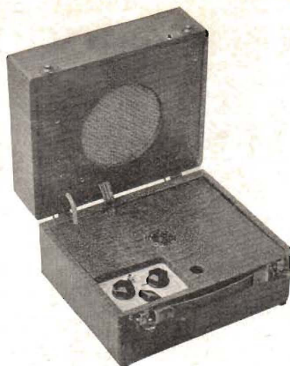
Modern engelsk rese-mottagare med tre rör, därav ett högfrekvensrör. Ramantenn och högtalare äro inbyggda i det uppfällbara locket.
