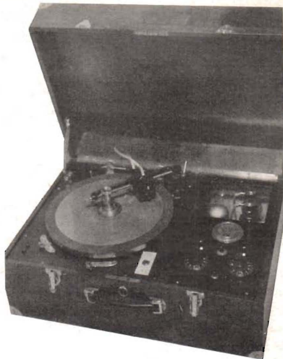
Väskan, som innehåller huvudförstärkare och graveranordning, är lätt transportabel. Förstärkaren kan vid behov lyftas ut ur väskan.
