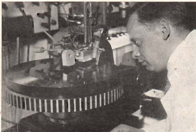
Vaxplattan graveras. Lägg märke till den stroboskopiska ringen på skivtallriken, vilken tjänar till att reglera in hastigheten till exakt 78 varv pr minut.
