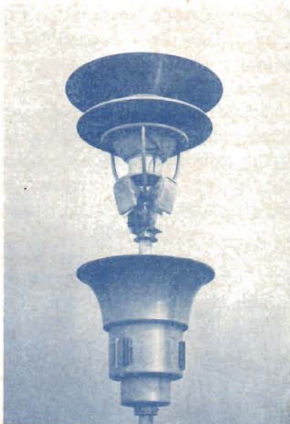
Telefunkens »Hochtonpils», en modernisering av »svamphögtalaren». Upptill ses den kraftiga elektrodynamiska högtalaren med sin svampformigt utbildade exponentialtratt och därunder två av de tre specialhögtalarna för det högre tonregistret. Den längre ned på stängen synliga kåpan är avsedd att skjutas upp omkring högtalaraggregatet.
