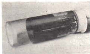
Katodstrålerör med keramisk sockel. (Leybold und von Ardenne.)
