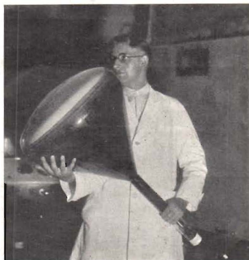
Jättestort katodstrålerör, avsett för televisionsmottagare med 32x27 cm bildyta. (Telefunken.)
