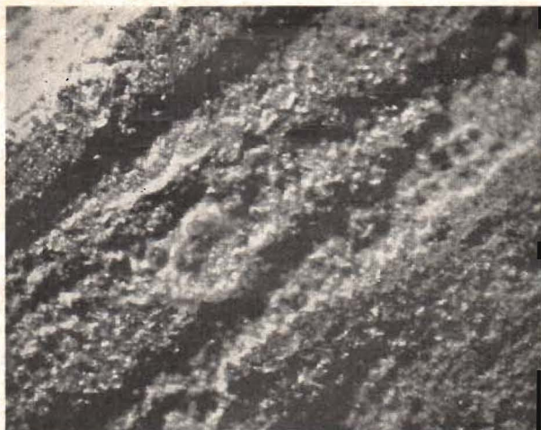
Fig. 5. Fotografi av en betsad aluminiumyta.
