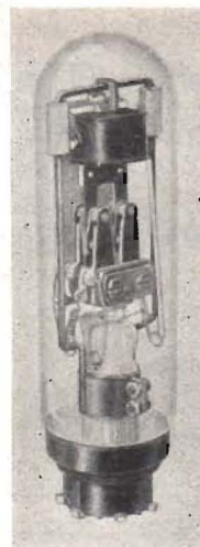
Vibrator, innesluten i vakuum till förhindrande av att kontakterna förstöras samt försedd med rörsockel.
