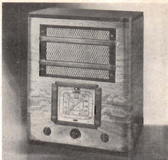
RCA-Victors modell 86T4, en 6-rörs superheterodyn med lång-, mellan- och kortvågsområde. I mitten av skalan finns en mikro-metervisare för kortvågsinställningen.
