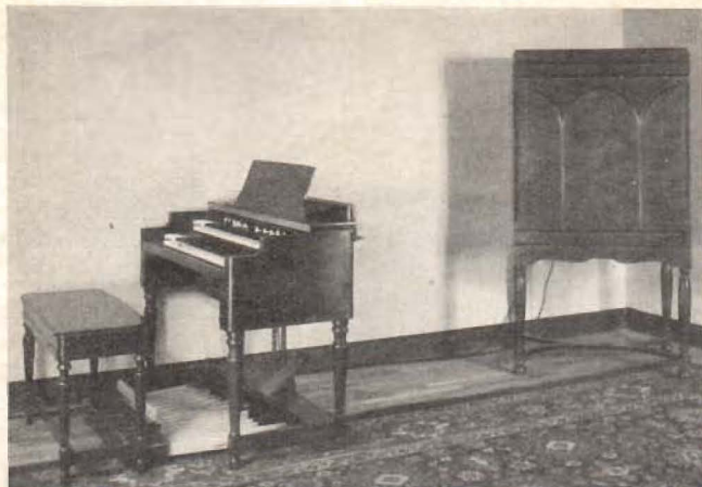
Hammond-orgeln komplett. Till vänster själva orgeln med tonmekanism och alla regleringar, till höger kraftförstärkaren och högtalarekabinettet. Denna installation räcker för en 1000 personers lokal.
