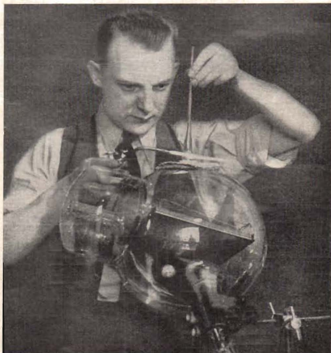
Fig. 5. Ett av Philcos ikonoskop under tillverkning.
