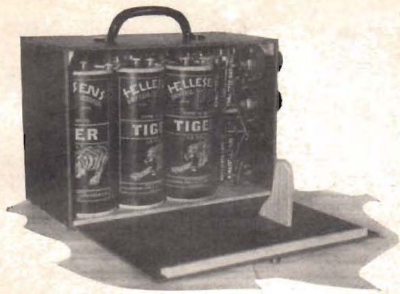
Batterilådan uppfälld. Längst fram de tre ringledningselementen, som leverera glödströmmen. Bakom dessa befinner sig anodbatteriet. Tråvingen på lockets insida håller glödströmsbatteriet på sin plats, då lådan är stängd.
