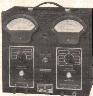
Clough-Brengles nya »analysator» (Super-Unimeter), modell 95, för mätning av kapaciteter och motstånd samt växel- och likspänningar.
