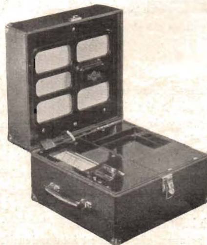
Fig. 3. Ett annat utförande av väskmottagare. Två avstämda kretsar, 4 rör (KF 4, KF 4, KC 1, KL 2), Sirufer-spolar, våglängdsområde 200—600 m och 1 000—2 000 m. Vikt utan batterier 6,6 kg, komplett 11,6 kg. Ramantenn med stark riktverkan. Specialackumulator för 60 driftstimmar. Driftskostnader ca 6 Pfennig per timme. Pris komplett inkl. rör, ackumulator och anodbatterier Rm. 248:—.
