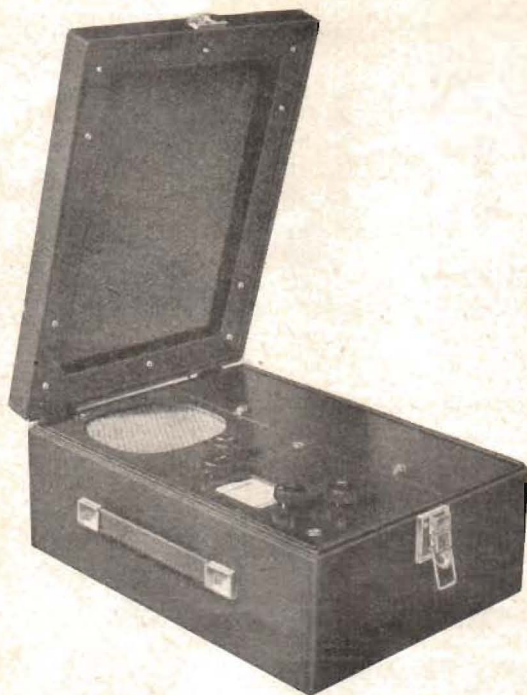
Fig. 2. Väskmottagare, 4-rörs tvåkretsmottagare med återkoppling (KF 4, KC 1, KC 1, KL 1). Inbyggd ramantenn med stark riktverkan. Permanentdynamisk högtalare. Driftskostnader 5 å 6 Pfennig per timme. Vikt komplett 9 kg. Dimensioner 36×27×15,5 cm. Pris komplett Rm. 170:—.
