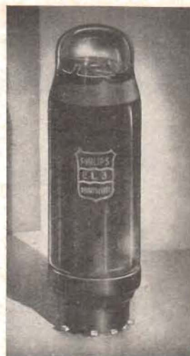
Fig. 5. Slutpentoden EL3, med samma data som växelströmsseriens AL4. I egenskap av slutrör har EL3 större dimensioner; höjden är 120 och diametern 37 mm.
