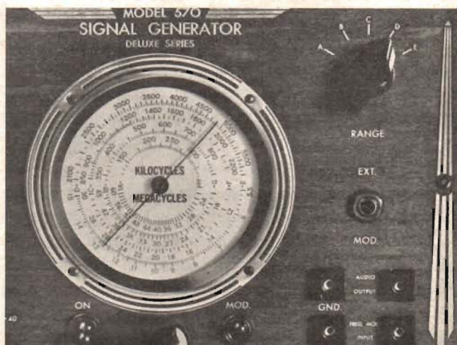
Närbild av skalan och frekvensomkopplaren. Områdena F, G och H gå på övertoner till området E.
