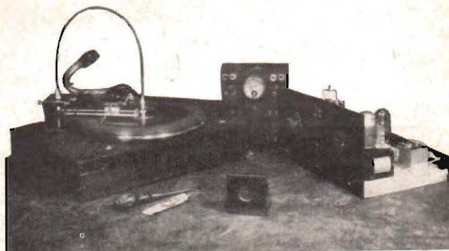
En komplett inspelningsapparat så när som på högtalaren. Mot-tagaren-förstärkaren är »Likströmstvåan» enl. Populär Radio, jan. 1934, och gravermekanismen är den i juli 1936 beskrivna. I för-grunden ses mikrofonen.
