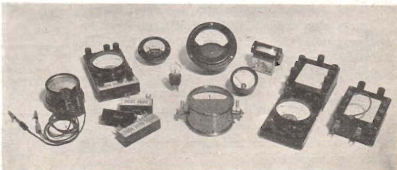
Fig. 1. Ett urval mätinstrument för ström- och spänningsmätning. Till vänster Weston-voltmeter med tre mätområden samt Mavometer med tillhörande shuntar och förkopplingsmotstånd. Till höger Mavometer med påsatt Maveco-tillsats för växelspänningar samt en annan tillsats för mätning av växelströmmar ned till 1 mA. I mitten några milliamperemetrar för likström av fabrikat Siemens & Halske, Weston och Neuberger samt ett termokors.
