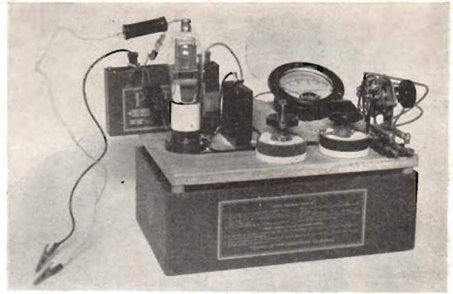
Fig. 11. Batteridrivna rörvoltmeter av reflexstyp. Den har tre mätområden: 0—2,5/10/40 V. Ett kortvågslör med galleruttag i toppen och arbetande med anodlikriktning ger ringa belastning av den mätta kretsen.
