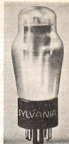
Ett amerikanskt rör av G-typ, således ett glasrör, försedd med den praktiska 8-poliga metallrörsockeln.
