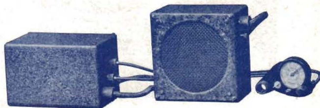
Fig. 6. Modern bilmottagare med separat högtalare. (»Ferranti».)
