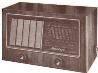
Fig. 13. »Standard Super 37» från Elektriska Aktiebolaget Skandia, en superheterodyn av normalstorlek med kontinuerligt variabel bandbredd.
