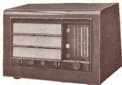
Fig. 17. »Radiola» modell 376, sjurörs superheterodyn med 22 cm »tonåtor» (högtalare) och 2 \mu V känslighet. Denna mottagare har optisk skala för underlättande av inställningen på kortvåg.
