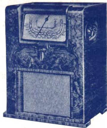
Fig. 5. Allvågssuper med automatisk selektivitetsförhöjning vid mottagning av avlägsna stationer. (»Cossor».)
