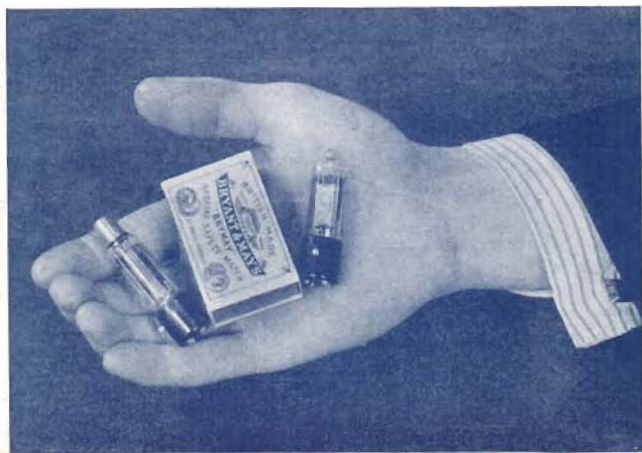
Fig. 7. Ett par miniatyrrör av märket »Hivac». En del nya typer funnos på utställningen.
