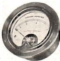
Fig. 7. Termoinstrumentet byggs i regel endast som milliampere- och amperemetrar med mätområden från 2,5 mA till 40 à 50 amp. De kunna användas för frekvenser upp till 70 miljoner Hertz. Härövan en termoamperemeter för området 0—5 amp., som lätt igenkännes på den »kvadratiske», mot nollpunkten starkt hopträngda skalan.
