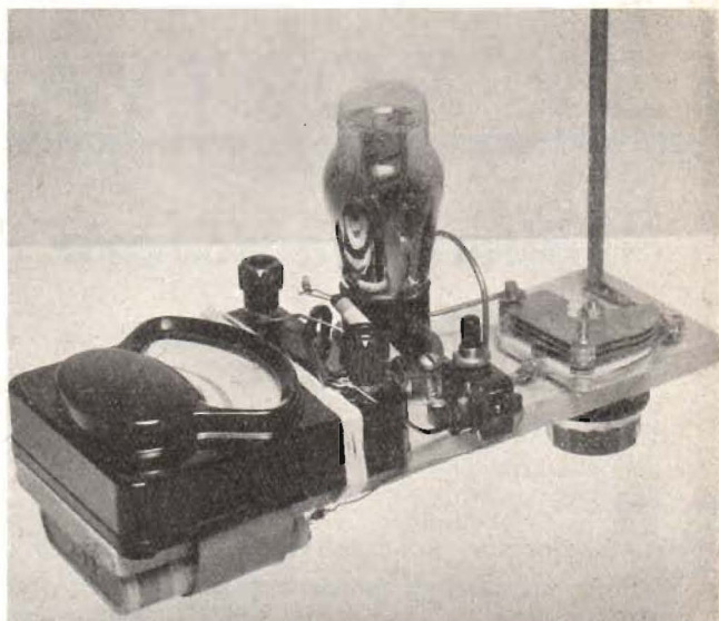
Denna bild visar hur enkelt man kan göra en fältstyrkemätare, om man monterar delarna på en brädlapp. Till höger om röret ses den som spole tjänstgörande trådslingan samt en strömbrytare.
