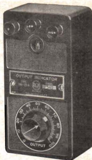
Fig. 5. RCA:s uteffektindikator, typ TMV-121-A. Detta instrument är huvudsakligen avsett att användas vid trimning av mottagare och arbetar med potentiometer och glimlampa. Tre impedanser finnas, 0,6, 1,5 och 4 ohm.
