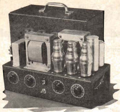
Förstärkaren med avtagen skyddshuv. Man ser regleringsorganen på chassiets framsida.
