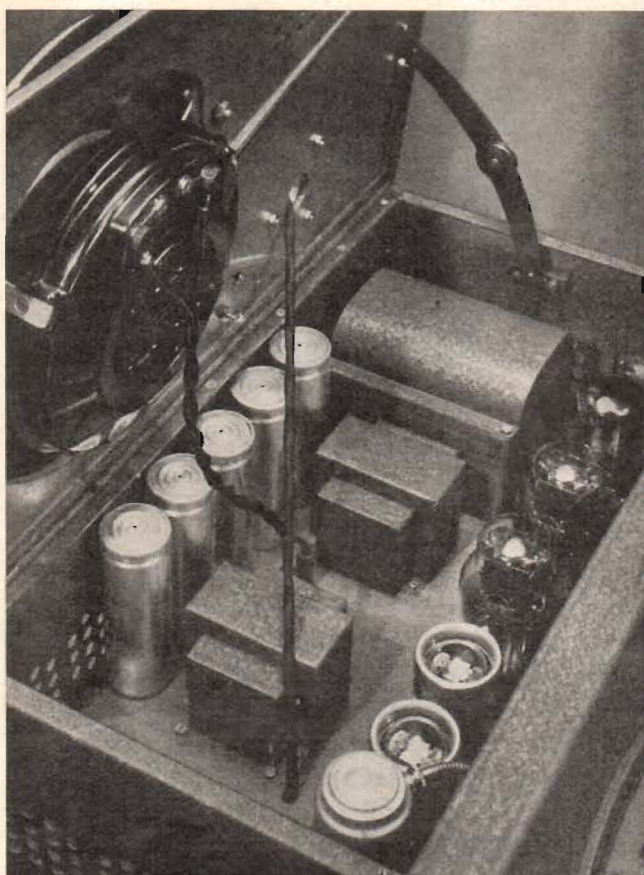
Fig. 2. På undersidan av det uppfällda locket ses synkronmotorn samt nere i lådan rör, transformatorer och elektrolytkondensatorer.
