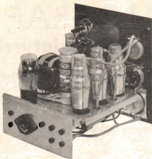
Chassiet uttaget ur lådan. Av de tre metallklädda rören är det närmast panelen gastriod, de två andra förstärkarrör. De skärmade ledningarna till ingångspotentiometrarna skulle kunna förkortas betydligt, om potentiometrarna monterades baktill på chassiet och försågos med förlängningsaxlar. Detta jämte lämplig monterning av rören skulle utöka frekvensområdet uppåt, men oscillografen skulle då bli mera skrymmande.
