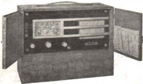
Allströmsmottagare i portativt utförande, »Wega», med 3+1 rör samt 2 kretsar. (Württembergische Radio Gesellschaft M. B. H., Stuttgart.)
