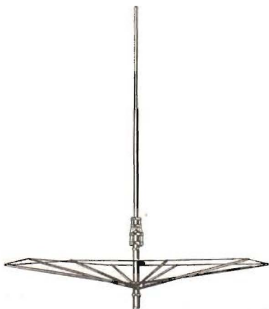
Fig. 1. Ny stavantenn med motvikt, avsedd att användas med skärmd nedledning, varvid motvikten anslutes till skärmen. (C. Schniewindt G. M. B. H.)
