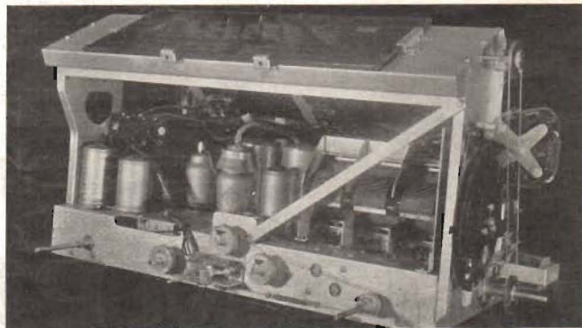
Chassiet till »Saba» modell 980 WLK, som har automatisk avstämning med motordrift. Man ser på högra gaveln motorn samt det av denna drivna stora kugghjulet på kondensatoraxeln. (A.-B. Harald Wällgren, Göteborg.)
