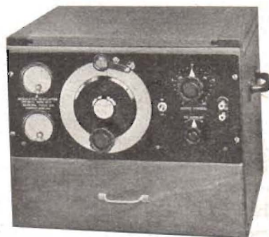
Fig. 9. Signalgenerator av enklare typ, general Radio 484—A. Denna signalgenerator kan användas för alstring av den önskade signalen i fig. 8, d. v. s. såsom mätsändare II.
