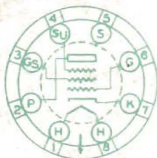
Fig. 1. Elektrodsystem och sockelkoppling hos »1231». Bromsgallret närmast anoden är fritt, så att röret kan användas som triod, tetrod eller pentod.
