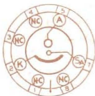
Fig. 1. Elektrodsystem och sockelkoppling hos Sylvania 0A4G. A : anod, K : katod, SA : hjälpanod.
